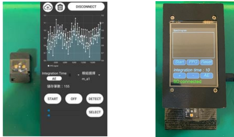
圖 10. 本團隊自研 AWPPG W-Type 裝置與量測 APP(左圖)及 P-Type 裝置(右圖)
